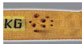
Повреждение в результате воздействия высокой температуры
