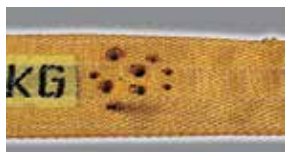
Повреждение в результате воздействия высокой температуры
