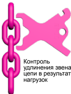
Контроль изменения \varnothing сечения звена вследствие износа
