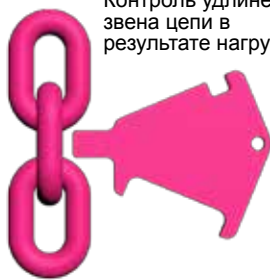
Контроль изменения \varnothing сечения звена вследствие износа
