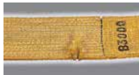
Повреждение основного шва
